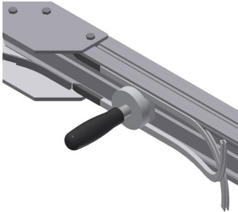
Bild. Montering av glidlist på undersida
